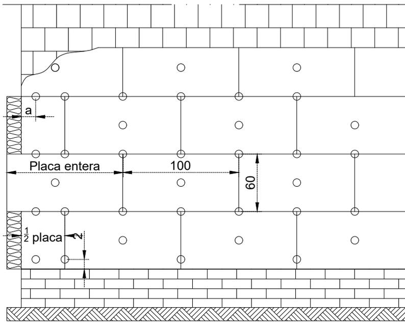
a > 5 cm para muros de hormigón, a > 10 cm para muros de ladrillo
