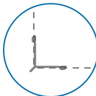
Perfil esquinero con red de fibra de vidrio termosoldada en ángulos convexos para asegurar la perfecta continuidad de la malla de refuerzo DANOTHERM® Malla 160 entre dos paramentos.
