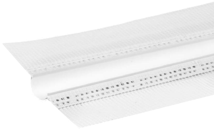
Junta con red de fibra de vidrio termosoldada para instalar entre los paneles aislantes en casos de uniones estructurales del edificio o en aquellas que es necesario garantizar una adecuada dilatación para la absorción de los movimientos de asentamiento en paredes continuas.
