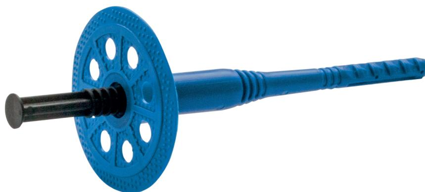
Taco de expansión de polipropileno de 8 mm de diámetro para fijación de paneles aislantes en el sistema de aislamiento térmico por el exterior DANOTHERM® SATE. Con homologación ETA06-0242 según ETAG014 para la categoría de uso B (ladrillo macizo) y C (ladrillo hueco).
