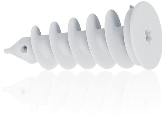
Fijaciones con forma helicoidal para instalación a posteriori o no planeada de cargas ligeras de hasta 5 kg en fachadas DANOTHERM® SATE de XPS o EPS, que incluye arandela de sellado.
