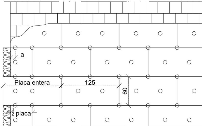
a > 5 cm para muros de hormigón, a > 10 cm para muros de ladrillo
